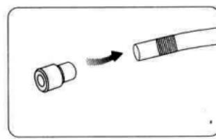
Примечание: После накачки шины закрутите винт форсунки шины на место.
