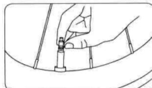
2. Установите штуцер узкого ниппеля шины на резьбовом газовом штуцере и подсоедините газовый штуцер к газовой насадке шины.
